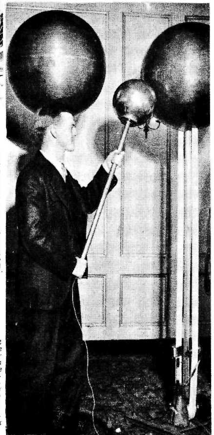
EL SECRETO DE LOS ALQUIMISTAS. —Lo que buscaron durante siglos los alquimistas de la Edad Media, sin poderlo encontrar, lo ha encontrado el profesor Roberto J. Van de GRAAF. Por medio de los grandes generadores que aparecen en la fotografía, produce descargas eléctricas y esas descargas de millones de voltios le han permitido transformar un metal en otro. Es verdad que el profesor De Graaf no puede todavía convertir el plomo en oro, como querían los alquimistas, pero en cambio convierte la plata en cadmio.
